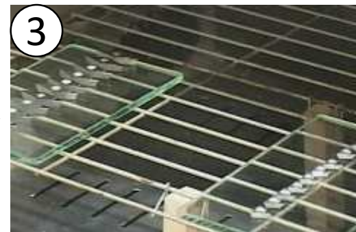
③ 20~30分、200℃のオーブンで乾燥させる Dry in an oven, temperature 200℃. (about 20~30 minutes)
