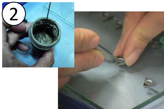
② ペーストを塗り、ダイヤをつける Put a Diamond with the paste.
